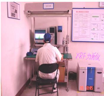
使用XRF测试仪测试部品的元素含量, 确保不使用环境负荷部品。
