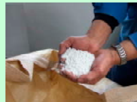
●発泡スチロールは空気を抜きフレーク状にされ、発泡スチロール用原料として再利用
