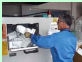
●発泡スチロールは空気を抜きフレーク状にされ、発泡スチロール用原料として再利用
