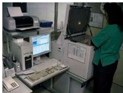
XRF検査(X線による含有物質分析)
